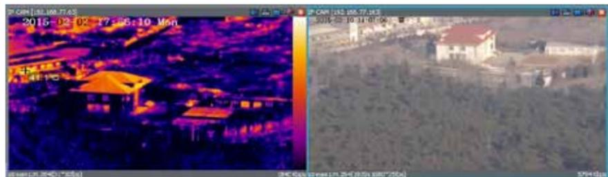
大家知道，任何温度在绝对零度（-273.5°C）以上的物体都是红外辐射的光源，利用热成像探测器被动接受目标本身和背景之间的红外辐射热差异，可以得到不同的红外热图。红外热成像设备能够看到任何有温度的物体，另外在成像时可以同步知道每个像素点的准确温度。区别于可见光的关键是 LWIR 处在一个特别有用的“大气窗口”中，具有穿透大气、烟云等特性，因此在光线差的烟雾等恶劣气候环境下，红外热成像照样威力不减。红外热成像与可见光双光谱融合，进行优势互补，在森林防火监控系统、安防领域大放异彩。另外，大部分工业制程设备都有相应的温度场分布，红外热成像技术不仅可以温度场转换为直观的图像外，结合智
